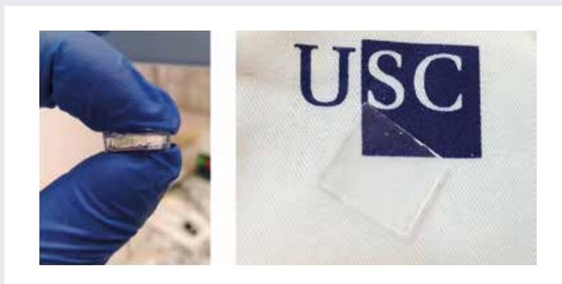
Figura 3. Muestras de electrolitos sólidos de diferente formato, confinando la mezcla del líquido iónico butil-metil-pirrolidinio bis (trifluorometilsulfonil) imida + litio bis (trifluorometilsulfonil) imida en una matriz de sílice usando como precursores de la gelificación el par Tetrametil ortosilicato (TMOS) / Dimetoxidimetilsilano (DMDMS).
