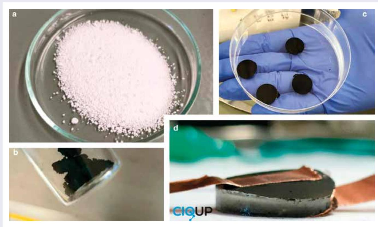
**Figura 6. Representación de (a) glucógeno obtenido del agua de cocción de mejillones, (b) carbono basado en glucógeno, (c) electrodos modificados con el carbono basado en glucógeno, (d) supercondensador que contiene el electrolito sólido.**
