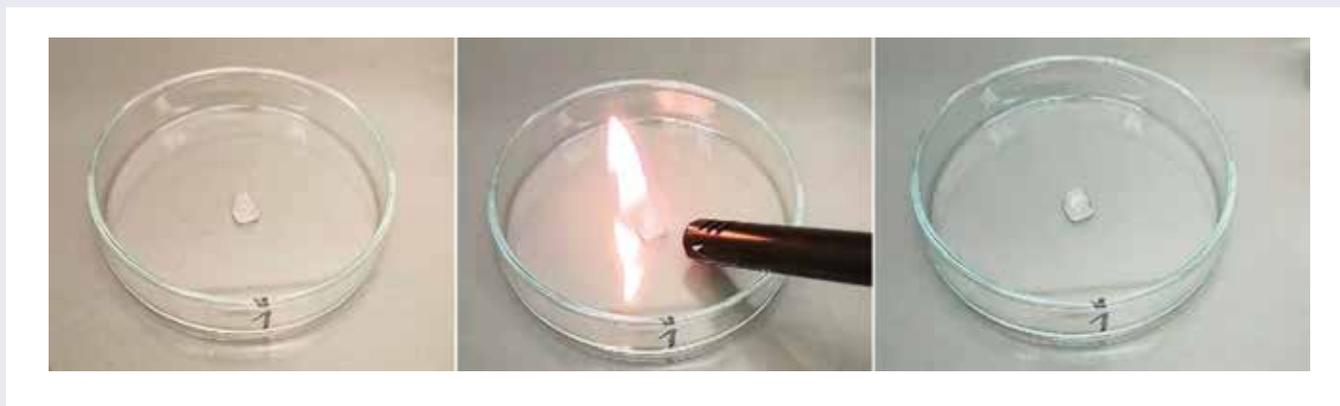
Figura 4. Ensayo de inflamabilidad de un ionogel.
